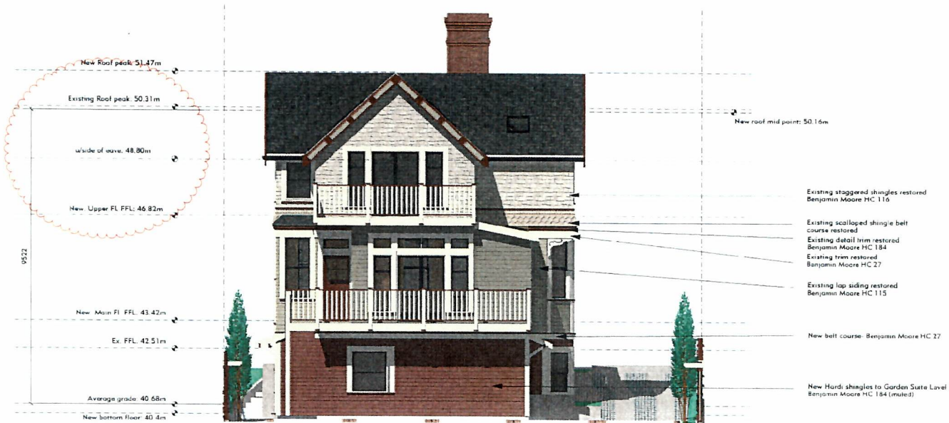
WEST ELEVATION scale: 1:50m
