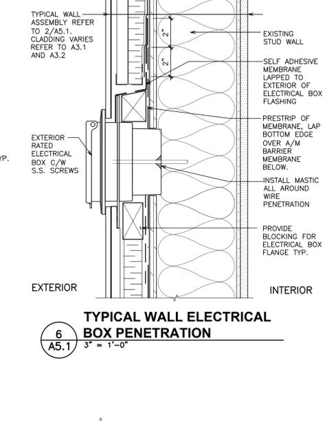
**6 TYPICAL WALL ELECTRICAL BOX PENETRATION**
