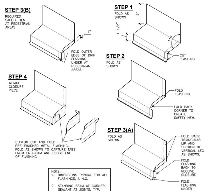
**1A TYPICAL FLASHING END DAM FORMATION**
