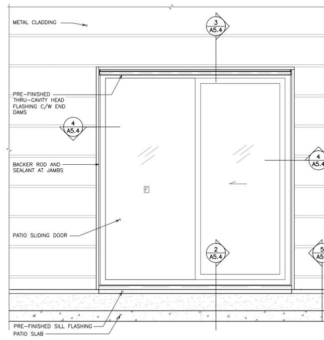
**1 SCHEMATIC SLIDING DOOR ELEVATION**
