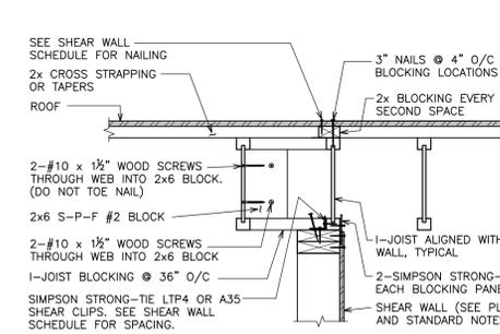
4 S1.3 1" = 1'-0" TYPICAL WALL TO TJI ROOF JOIST CONNECTION WHERE JOISTS RUN PARALLEL TO WALL
